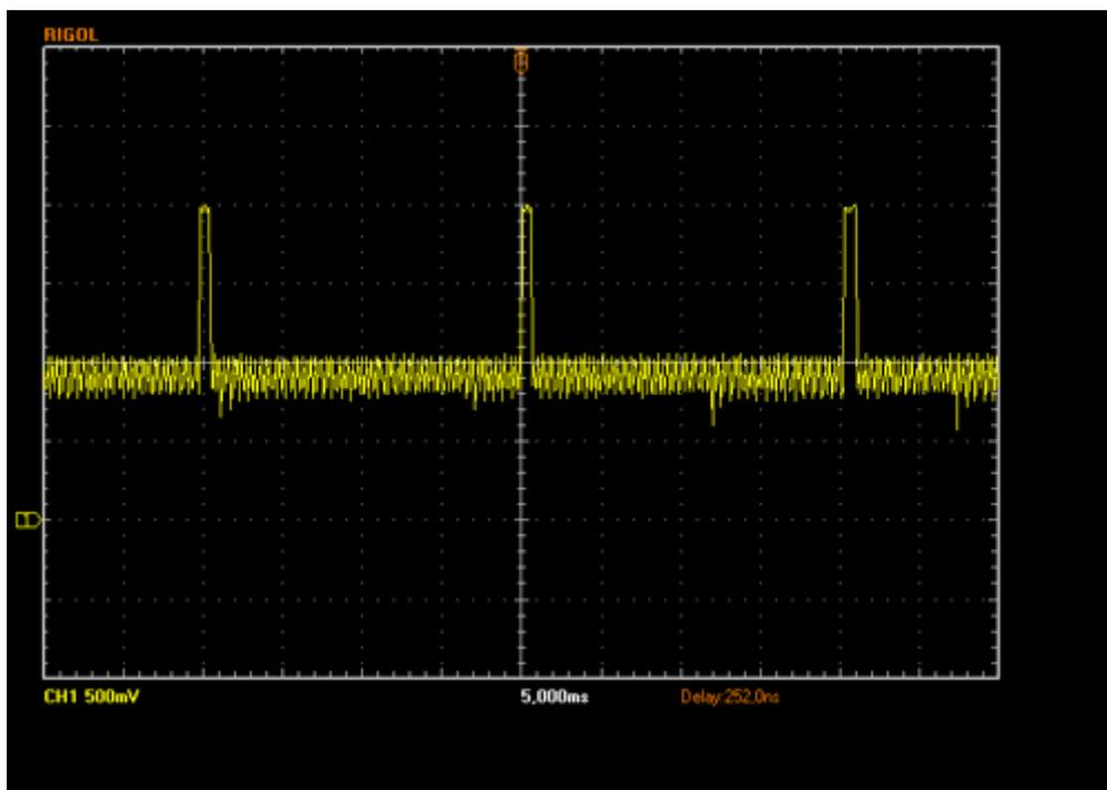
№5. Вывод 49. При подключенном НОТ и исправной шине LFB.
