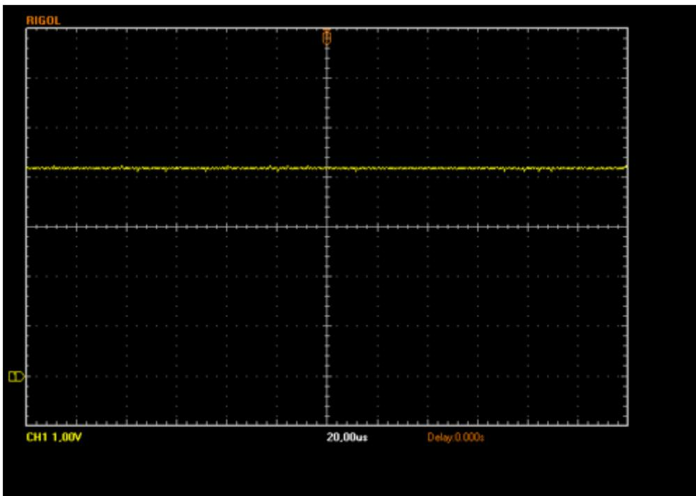
№3. Вывод 49. При отключенном НОТ и неисправной шине LFB.
