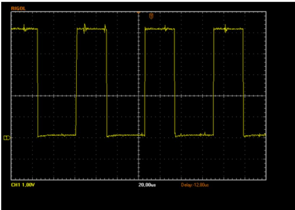
№2. Вывод 48. Неисправна шина LFB – обрыв цепи.
